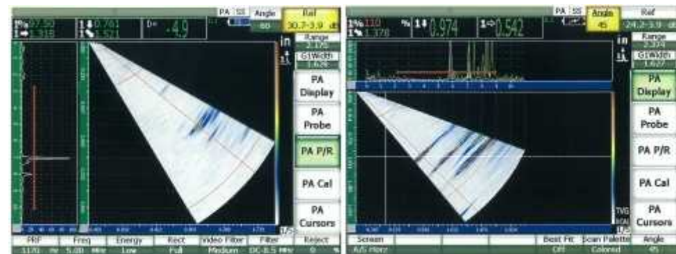
フェイズドアレイ超音波探傷器による損傷部の表示例
