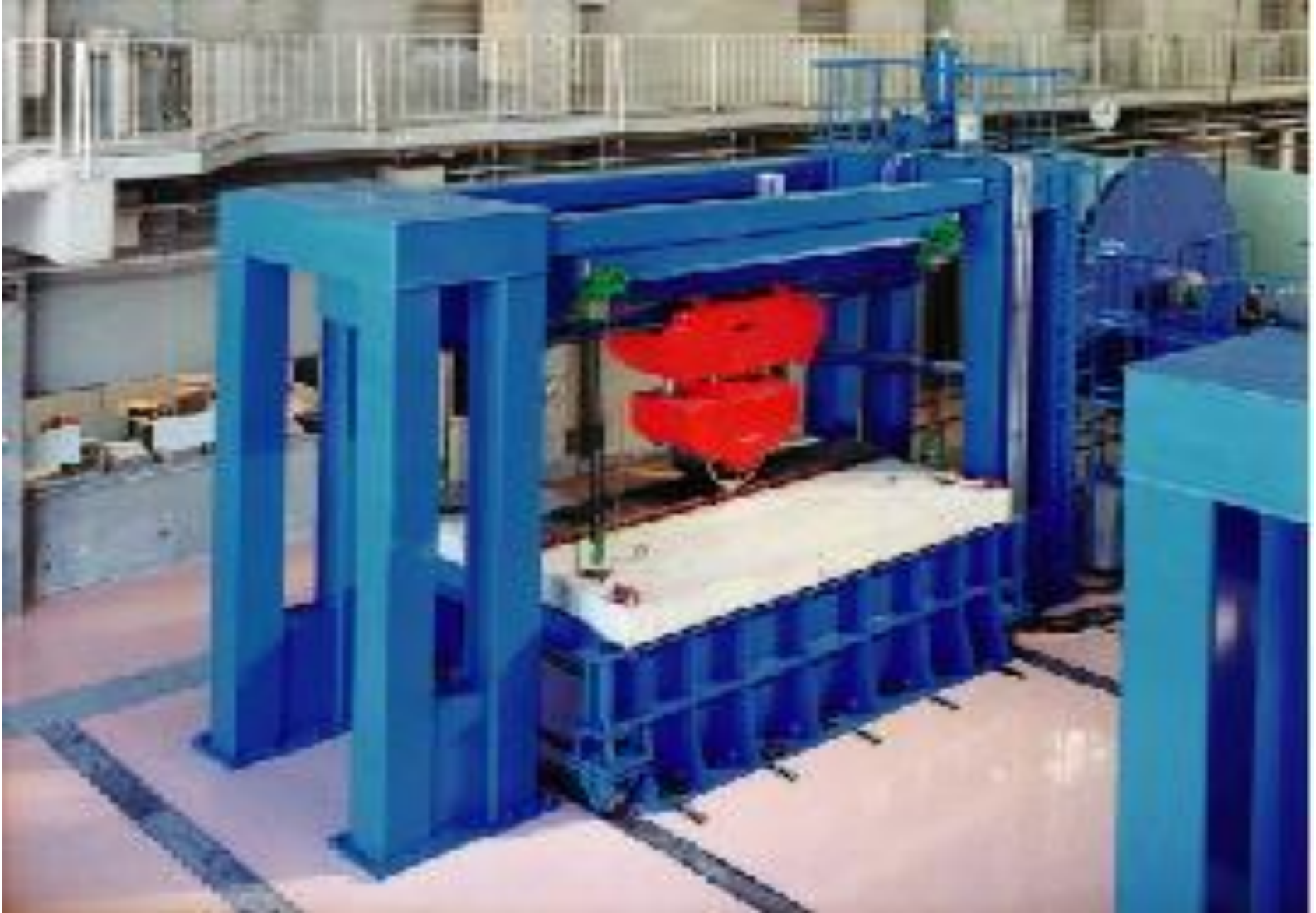
土木研究所の輪荷重走行試験機(1996) (新規の補修法などの検証)
